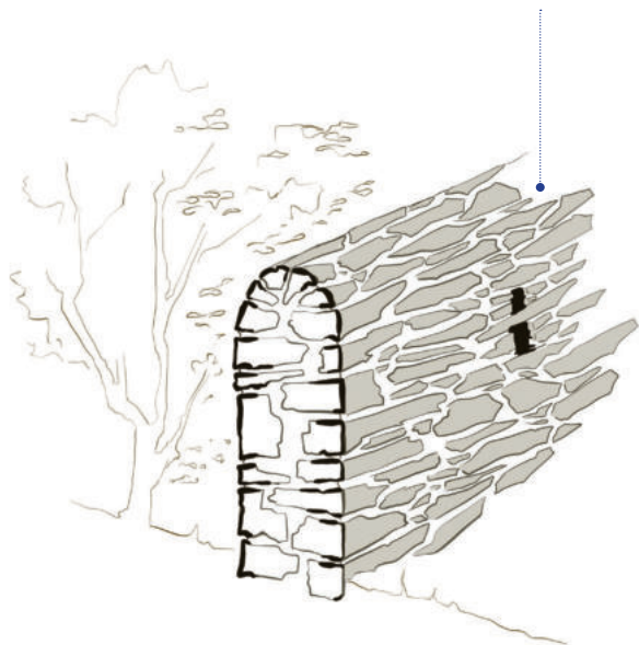
Muret en moellons de schiste à couronnement «en dôme»
